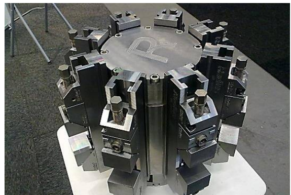
Kontrollerad och optimal bearbetning av flera detaljer med GibbsCAM TMS och snabbfixturer från svenska Radius.
